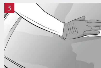
3 Appliquer l'agent de préparation sur les surfaces à traiter et laisser sécher.
