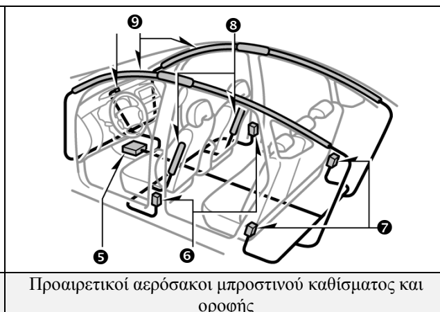
Τυπικοί μετωπικοί αερόσακοι και προεντατήρες ζωνών ασφαλείας
